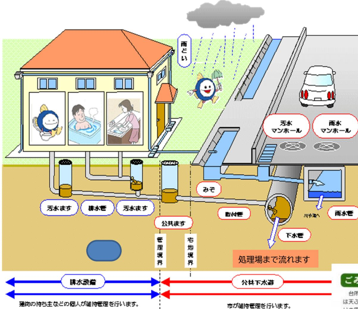
下水道は、大きく分けて汚水と雨水を併せて排水する「合流式」と汚水と雨水を分けて排水する「分流式」の2種類に大別されます。(左図参考)
