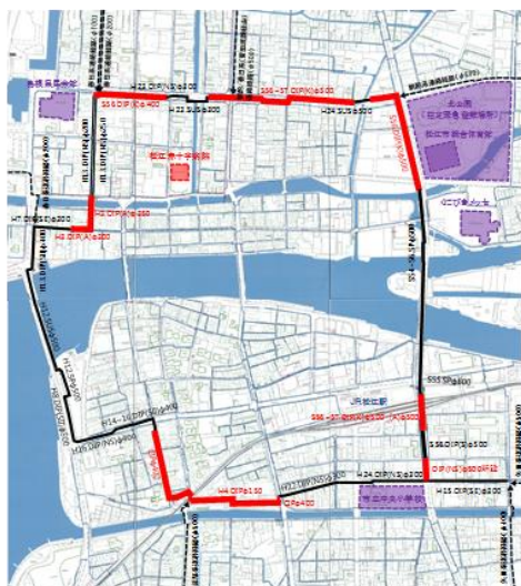
図7：中央ループ管路の図面
